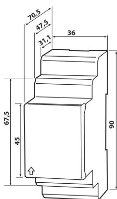
Die Frontplattenabdeckung ist an der mit einem Pfeil gekennzeichneten unteren Seite aufzuklappen.
