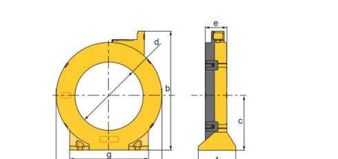
DE Abmessungen (in mm), Toleranz: ±0,5 mm
